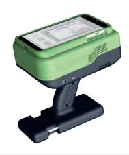
Лазер 532 нм Разрешение от 6 см<sup>-1</sup> Время измерения < 3 с. Время готовности прибора к работе - 2 минуты
